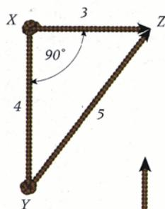
ARRIBA, DERECHA. El empleo de cuerdas anudadas fue un método egipcio muy común para fijar con rapidez triángulos agrimensores.
