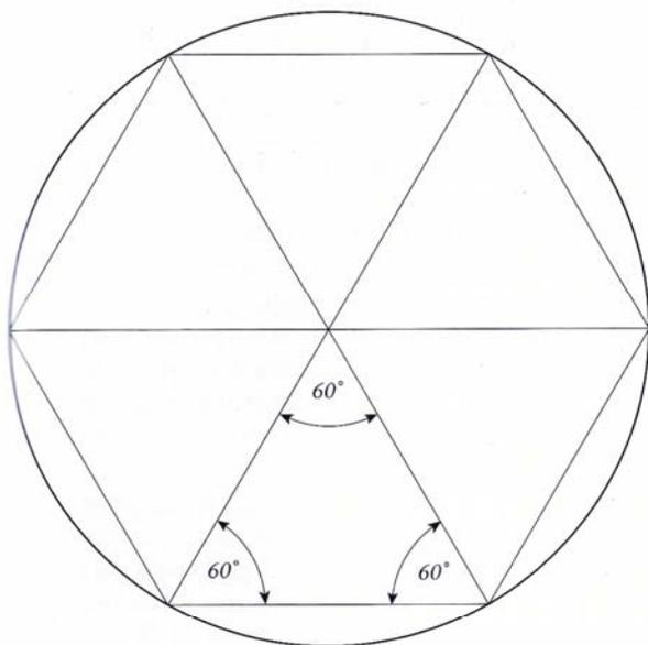
ARRIBA. El triángulo equilátero se emplea para generar un hexágono regular. Todos los ángulos internos del triángulo miden  $60^\circ$ .
