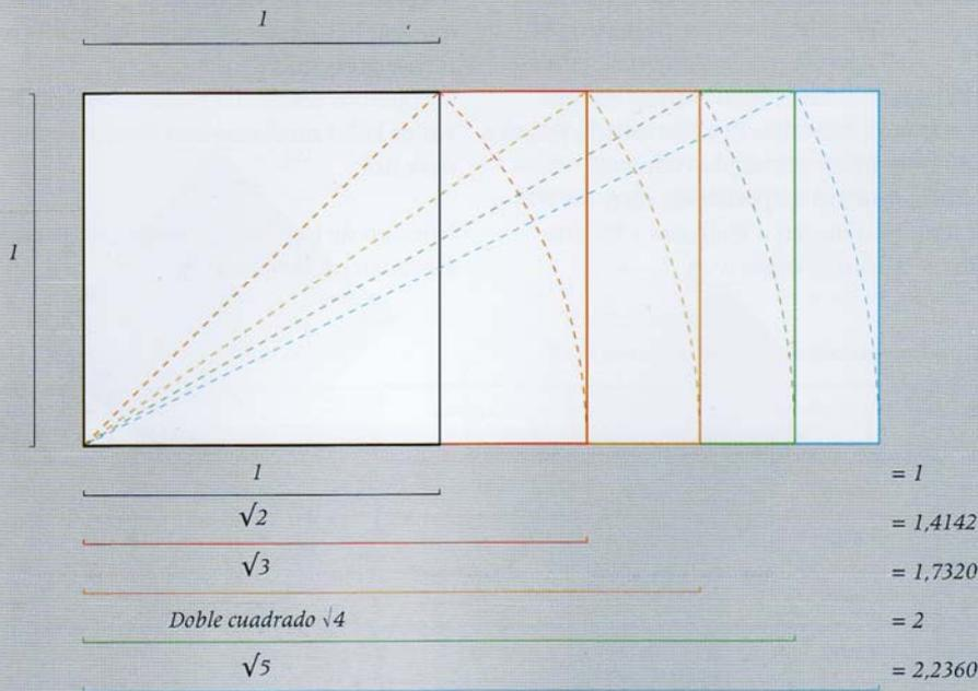
**IZQUIERDA.** Empezando con un cuadrado (de lado 1 unidad) y utilizando sólo un compás y una regla, podemos construir rectángulos raíz de longitud  $\sqrt{2}$ ,  $\sqrt{3}$  y  $\sqrt{5}$ .
