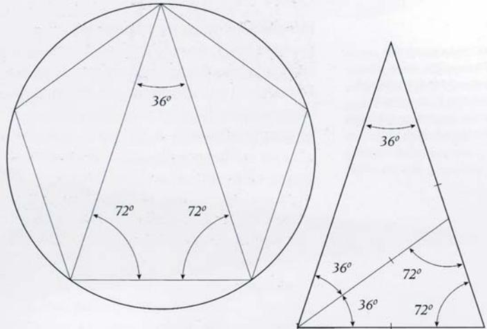
**ARRIBA.** Se puede construir un triángulo áureo en cada uno de los cinco lados de un pentágono regular. El triángulo áureo tiene los dos ángulos de la base de  $72^\circ$ ; se puede trazar la bisectriz de cualesquiera de ellos para formar otro triángulo áureo, y así hasta el infinito.
