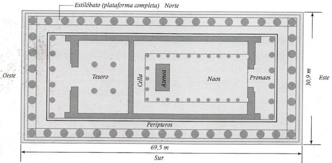
ARRIBA. Plano del Partenón en el que se muestra la entrada por el este, y la estructura del templo interior (naos) y del lugar donde se guardaba el tesoro con sus dimensiones respectivas.
